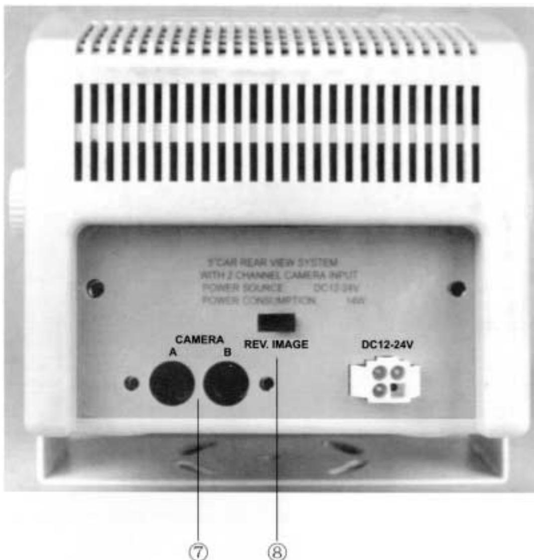
Vue arrière du moniteur montrant les connexions d'entrée/sortie.
